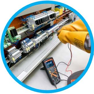
Las mediciones del bucle de corriente 4-20 mA en sistemas analógicos de control del funcionamiento de sensores de temperatura, presión, humedad o flujo son posibles gracias a una función especial que muestra los resultados porcentuales para los correspondientes valores de corriente.
