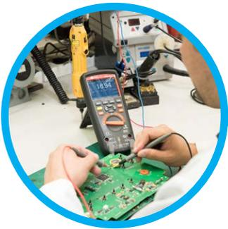
El medidor permite las mediciones de intensidades muy pequeñas en un rango hasta **500 µA** durante trabajos de mantenimiento, por ejemplo en pruebas de sistemas de alimentación de un reloj en tiempo real o en el mantenimiento de sensores de llama en cámaras de combustión.
